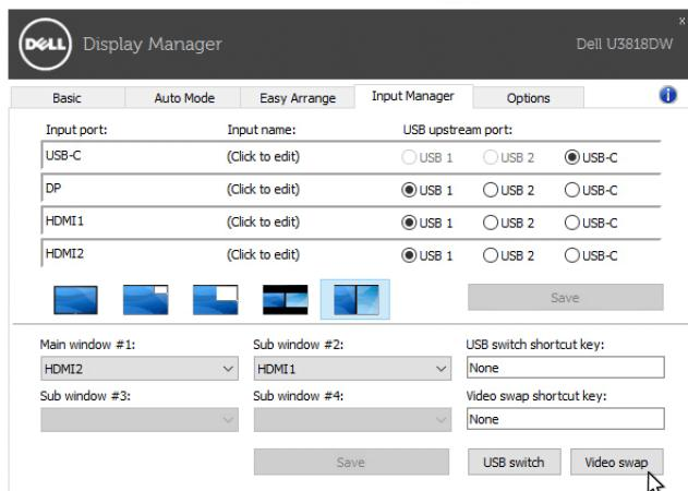
Video girişiniz ile bir USB karşıya yükleme bağlantı noktasını atayabilirsiniz. Video monitörünüzde gösterildiğinde atanan USB karşıya yükleme bağlantı noktası bilgisayarınıza bağlanacaktır.
